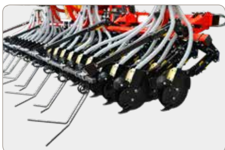
Erpice copriseme con molla a coda di rondine disponibile anche per elementi di semina con ruotino.
