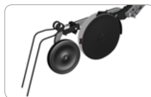
Assolcatore a doppio disco con ruotino controllo profondità.
